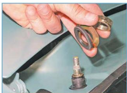
...и снимаем с вала мотор-редуктора гайку, шайбу и уплотнитель. Аналогичные операции выполняем на другом валу очистителя. Нажав на фиксатор...
