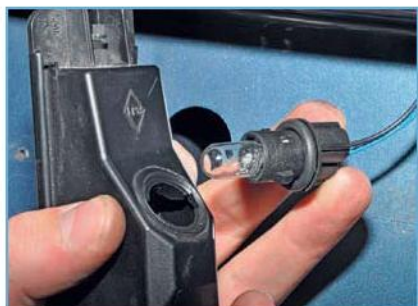
Повернув против часовой стрелки, вынимаем патрон с лампой из корпуса фонаря.
