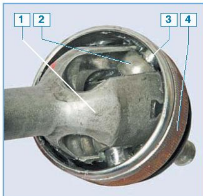
Наружный шарнир привода: 1 – кулак; 2 – ролик; 3 – трехшиповик; 4 – корпус шарнира
