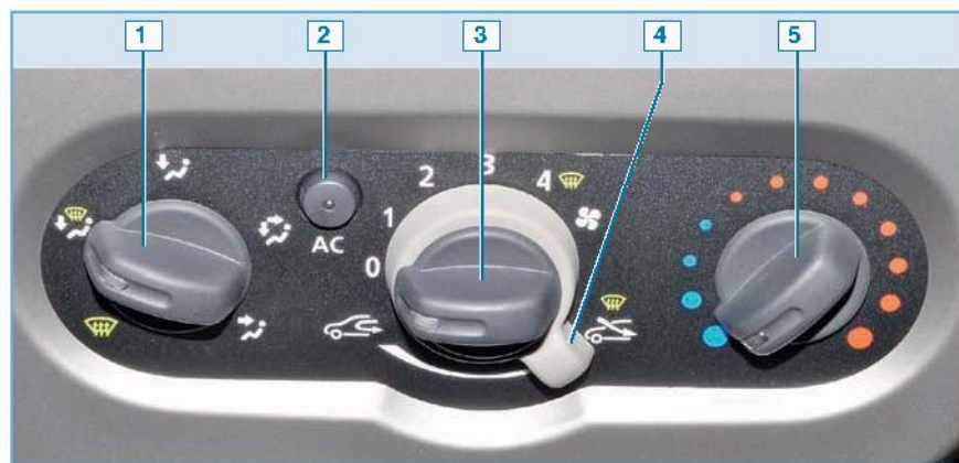
Блок управления отоплением, вентиляцией и кондиционированием: 1 – регулятор распределения потоков воздуха; 2 – выключатель кондиционера; 3 – переключатель режимов работы вентилятора; 4 – рычаг управления режимом рециркуляции воздуха; 5 – регулятор температуры воздуха
