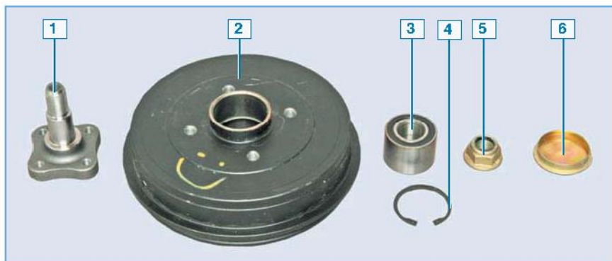
Узел подшипника заднего колеса: 1 – цапфа; 2 – барабан тормозного механизма; 3 – подшипник заднего колеса; 4 – стопорное кольцо подшипника; 5 – гайка подшипника; 6 – колпачок
