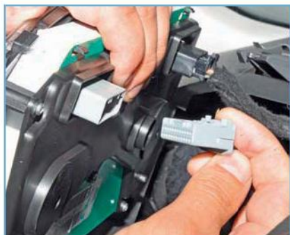
...и нажав на фиксатор, отсоединяем от нее колодку проводов серого цвета.
