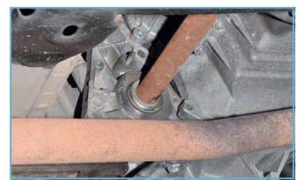
Место выхода из картера коробки передач автомобиля Sandero Stepway удлиненного корпуса внутреннего шарнира привода правого колеса
