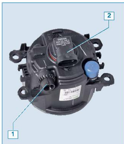
Противотуманная фара: 1 – регуляционный винт; 2 – лампа фары
