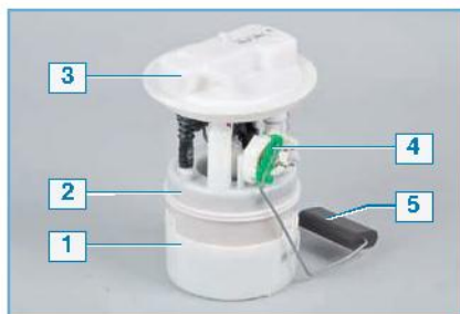
Топливный модуль: 1 – стакан; 2 – топливный фильтр; 3 – крышка модуля; 4 – датчик указателя уровня топлива; 5 – поплавков
