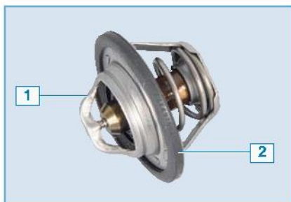
Термостат: 1 — термостат; 2 — уплотнительное кольцо
