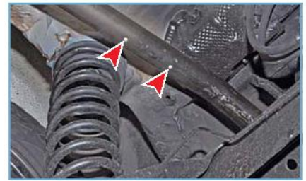
Расположение меток на трубе между дополнительным и основным глушителями
