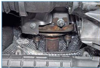
Соединение приемной трубы с выпускным коллектором
