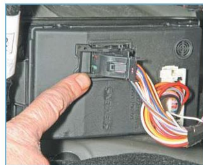
...и поворачивая скобу фиксатора, отсоединяем колодку жгута проводов от блока.
