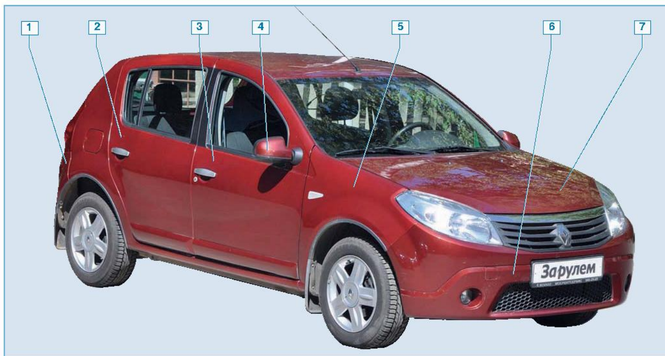
Съемные элементы кузова Sandero: 1 – задний бампер; 2 – задняя дверь; 3 – передняя дверь; 4 – наружное зеркало заднего вида; 5 – переднее крыло; 6 – передний бампер с облицовкой радиатора; 7 – капот
