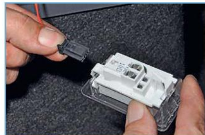
Нажав на фиксатор, отсоединяем колодку проводов от разъема фонаря.
