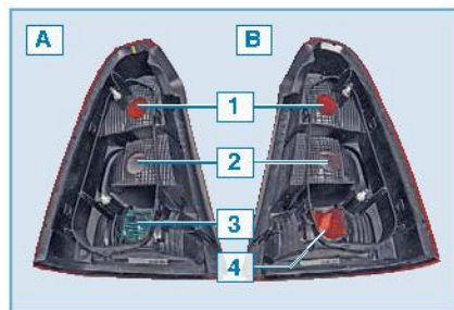
Расположение ламп в задних фонарях: А – правый фонарь; В – левый фонарь; 1 – сигнала торможения и габаритного света; 2 – указателя поворота; 3 – света заднего хода; 4 – противотуманного света
