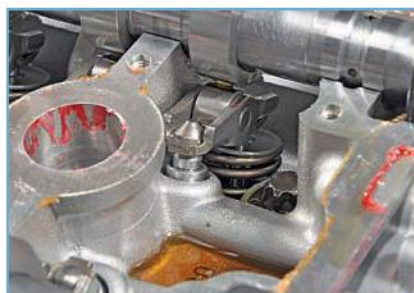
Одним концом рычаг опирается на сферическую головку гидроопоры (гидрокомпенсатора зазора), а другим воздействует на торец стержня клапана
