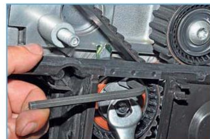
Привод газораспределительного механизма: 1 – зубчатый шкив коленчатого вала; 2 – ремень привода ГРМ; 3 – ролик натяжного устройства; 4 – зубчатый шкив распределительного вала привода выпускных клапанов; 5 – зубчатый шкив распределительного вала привода впускных клапанов; 6 – опорный ролик; 7 – зубчатый шкив насоса охлаждающей жидкости
