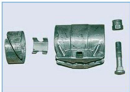
Соединяют трубы нового узла с трубами системы выпуска специальным хомутом
