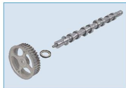
Распределительный вал с зубчатым шкивом и сальником
