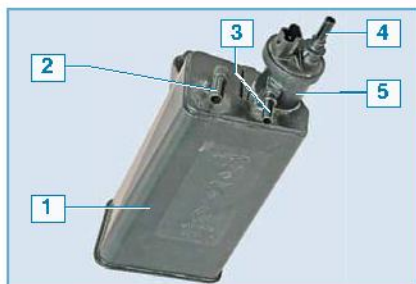
Элементы адсорбера: 1 – адсорбер; 2 – штуцер подвода воздуха; 3 – штуцер подвода паров топлива из бака; 4 – штуцер электромагнитного клапана; 5 – электромагнитный клапан
