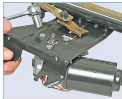
Головкой «на 10» отворачиваем три болта крепления мотор-редуктора к кронштейну очистителя...
