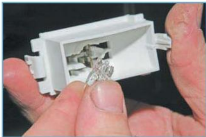
Вынимаем лампу из плафона. Вставляем новую лампу W5W и устанавливаем плафон освещения багажника в обратной последовательности. Для замены плафона вынимаем его из отверстия в задней полке (см. выше).
