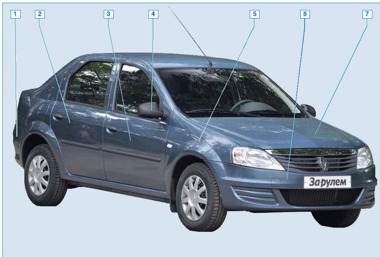
Съемные элементы кузова Logan: 1 – задний бампер; 2 – задняя дверь; 3 – передняя дверь; 4 – наружное зеркало заднего вида; 5 – переднее крыло; 6 – передний бампер с облицовкой радиатора; 7 – капот
