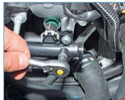
Головкой «на 8» отворачиваем два болта крепления топливной рампы к впускному трубопроводу.
