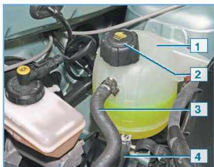
Элементы расширительного бачка: 1 – бачок; 2 – крышка заливной горловины; 3 – пароотводящий шланг; 4 – наливной шланг
