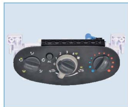
Блок управления отоплением, вентиляцией и кондиционированием воздуха
