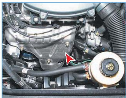
Выпускной коллектор закрыт теплозащитным экраном...
