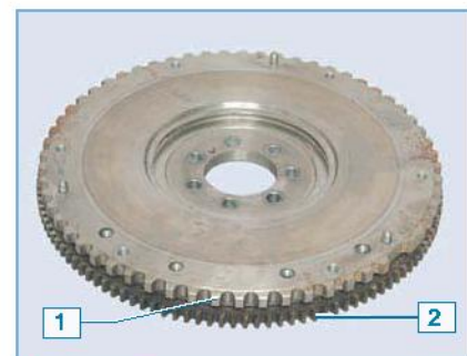
Маховик: 1 – венец для датчика положения коленчатого вала; 2 – венец для пуска двигателя
