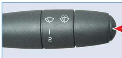
Правый подрулевой переключатель (автомобиль Logan) (стрелкой обозначена кнопка управления отображением данных на дисплее бортового компьютера)
