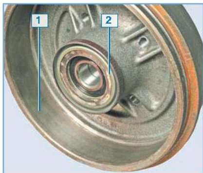
Расположение задающего диска датчика скорости вращения заднего колеса: 1 – барабан тормозного механизма; 2 – задающий диск датчика скорости
