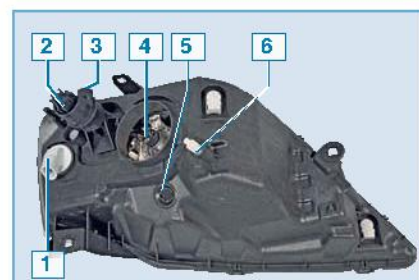
Блок-фара автомобиля Logan: 1 – патрон лампы указателя поворота; 2 – исполнительный механизм регулятора направления пучков света фары; 3 – винт регулировки пучка света фары в вертикальной плоскости; 4 – лампа головного света; 5 – гнездо лампы габаритного света; 6 – ручка регулировки пучка света фары в горизонтальной плоскости
