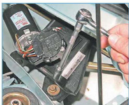
Головкой «на 10» отворачиваем болт крепления кронштейна очистителя.
