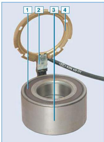
Элементы датчика скорости вращения переднего колеса: 1 – защитная шайба подшипника; 2 – датчик скорости; 3 – подшипник ступицы; 4 – установочное кольцо датчика скорости
