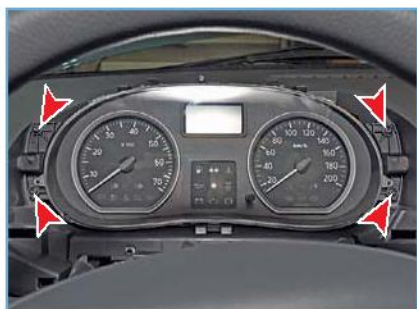
Ключом Torx T-20 отворачиваем четыре самореза крепления комбинации приборов.
