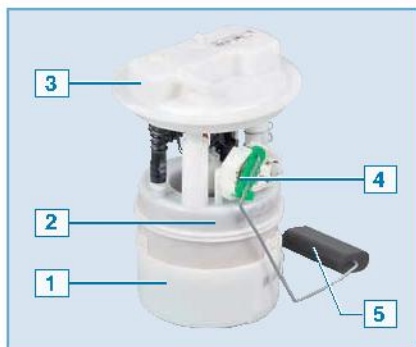
Топливный модуль: 1 – стакан; 2 – топливный фильтр; 3 – крышка модуля; 4 – датчик указателя уровня топлива; 5 – поплавок
