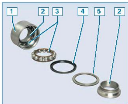
Устройство двухрядного подшипника ступицы (для наглядности элементы одного ряда извлечены из наружного кольца подшипника): 1 – наружное кольцо подшипника; 2 – внутреннее кольцо подшипника; 3 – сепаратор с шариками; 4 – сальник; 5 – защитная шайба
