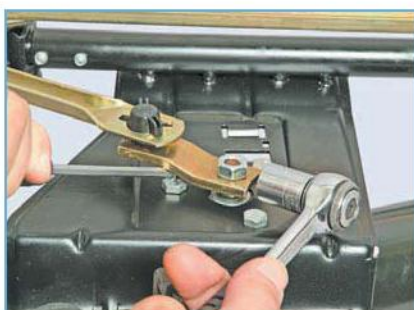
Головкой «на 13» отворачиваем гайку крепления кривошипа очистителя, удерживая кривошип отверткой.
