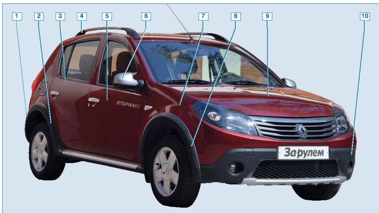
Съемные элементы кузова Sandero Stepway: 1 – задний бампер; 2 – облицовка арки заднего колеса; 3 – задняя дверь; 4 – рейлинги; 5 – передняя дверь; 6 – наружное зеркало заднего вида; 7 – переднее крыло; 9 – капот; 8 – облицовка арки переднего колеса; 10 – передний бампер с облицовкой радиатора
