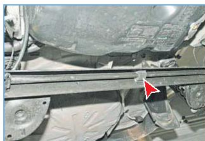
В средней части на стабилизаторе установлена резиновая подушка
