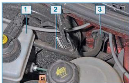
Элементы гидропривода сцепления автомобиля Sandero Stepway: 1 – бачок главного тормозного цилиндра и цилиндра сцепления; 2 – трубка подвода жидкости к главному цилиндру сцепления; 3 – главный цилиндр сцепления
